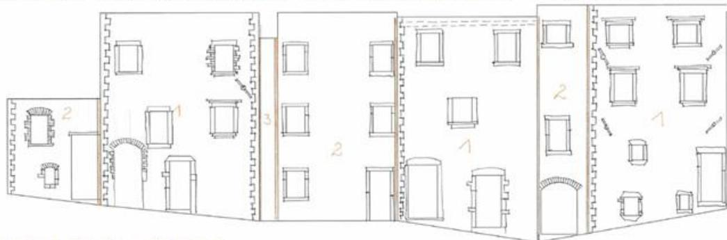
Riconoscimento delle fasi realizzative dall'osservazione delle murature
